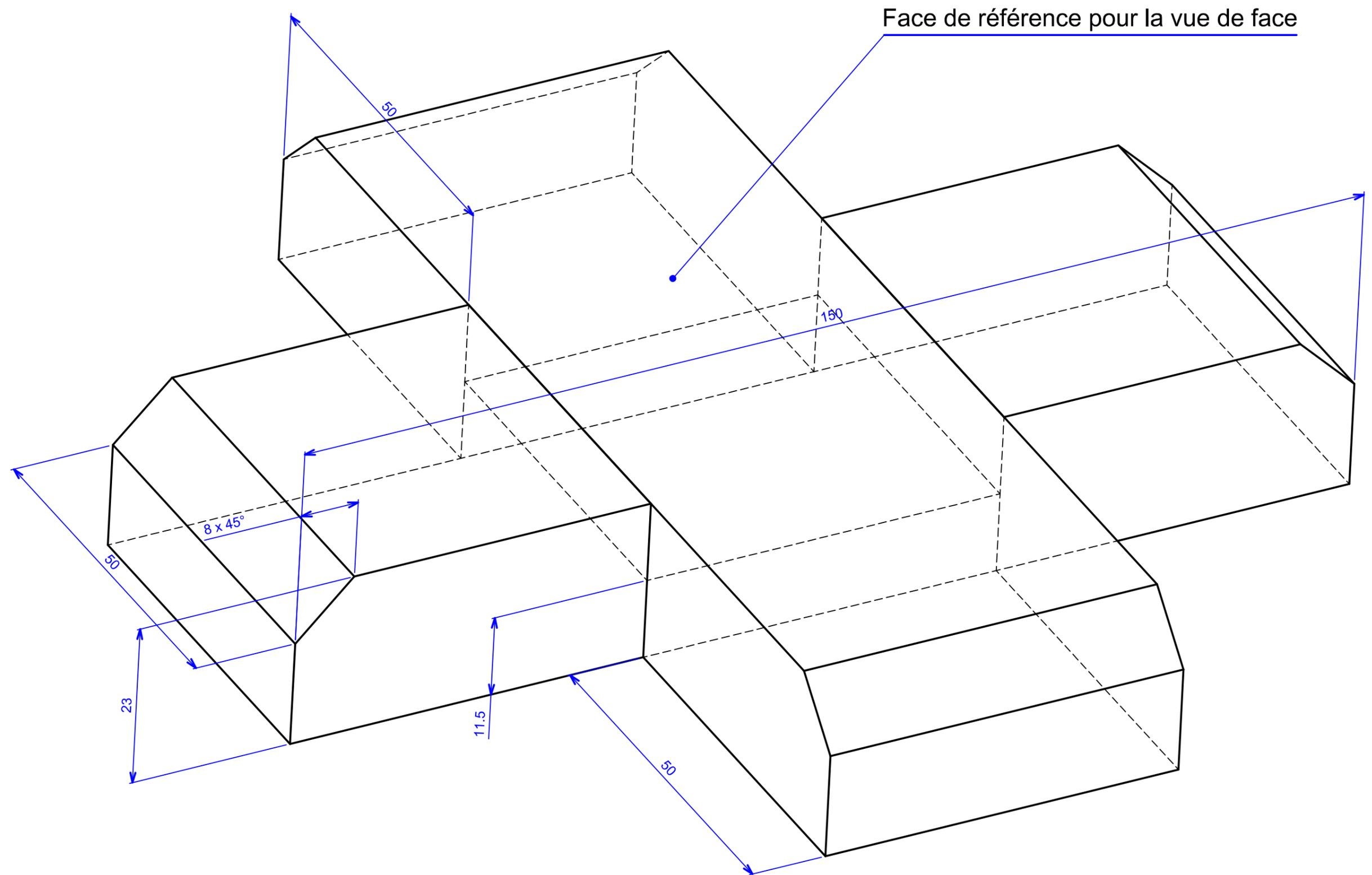
Réaliser sur le document 2/2 la vue de face et la vue de gauche de l'ensemble "Assemblage mi-bois" à l'échelle 1.
