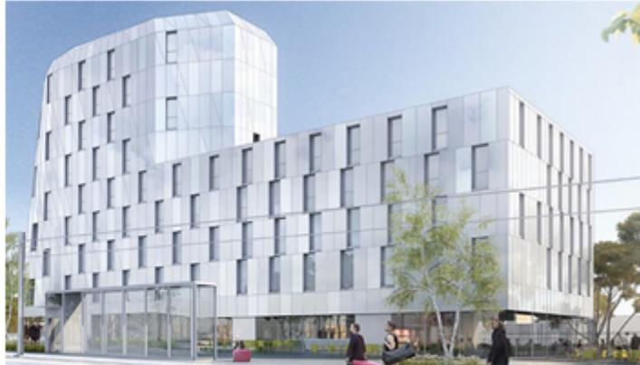
Au rez-de-chaussée, la couleur argentée des cassettes métalliques s'affichera dans des tons mats. Cette teinte deviendra de plus en plus brillante au fur et à mesure qu'on monte vers le 8e niveau, les reflets se mélangeant avec la couleur du ciel.
