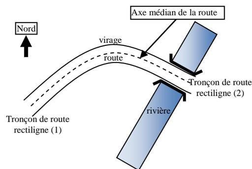
[OA] et [BC] sont des segments de droite et  $\widehat{AB}$  est un arc de courbe. L'objet du travail est de vérifier le respect des contraintes de raccordement.
