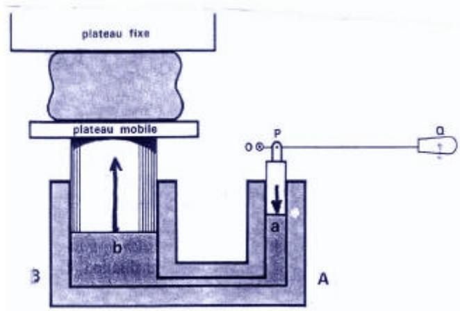
\* au niveau du grand piston, la surface de la section vaut  $S$  et la force appliquée  $\vec{F}$
