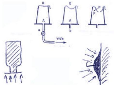
$\Rightarrow$  Mesure de la pression atmosphérique : principe du baromètre
