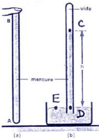
Expérience de Torricelli : un tube rempli de mercure est retourné sur une cuve à mercure : le niveau de mercure se stabilise à la hauteur DC : cette hauteur correspond à la pression de l'air exercée sur la surface du mercure.
