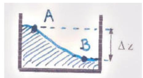
\* VASES COMMUNIQUANTS : niveau d'eau, indicateur de niveau, fonctionnement d'une écluse, principe du siphon, distribution d'eau dans les agglomérations, ...
