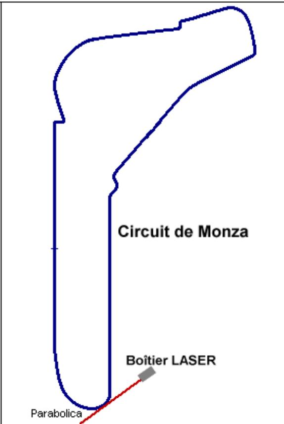
Un détecteur LASER est posé sur le bord de la piste, à la sortie du virage, afin d'étudier la trajectoire de la monoplace.
